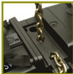
Механизм протяжки цепи не допускает перекоса
